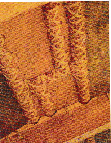
Neubau eines 20m Rumples mit den dicken Kokosnusswästen der vernähten Planken
